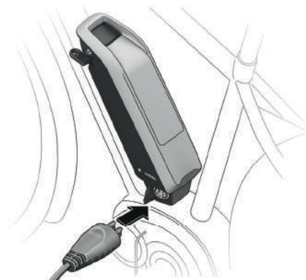
Abbildung 29: Einstecken des Ladegerätsteckers in die Ladebuchse am unteren Teil der Akkuhalterung
