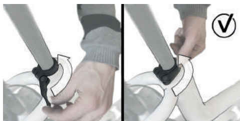
Image 8 : Fermer le blocage rapide de la tige de selle
