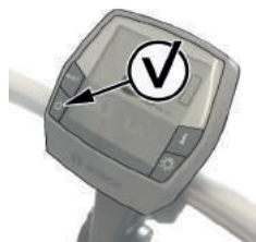
Abbildung 21: Ein- und Ausschalten des Displays
