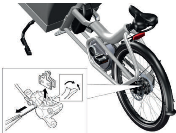
Abbildung 38: Entfernen der Bremsbeläge, um sie auf Verschleiß zu prüfen
