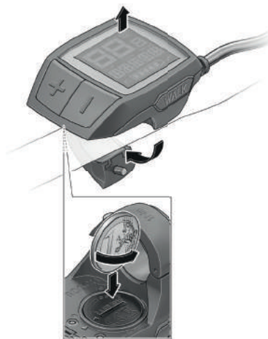
Afbeelding 31: De batterijen van het Purion display vervangen
