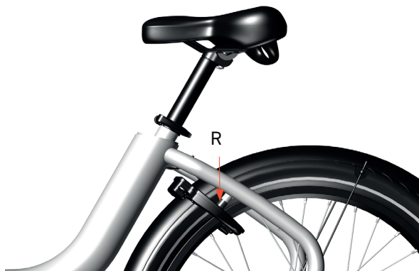
Abbildung 37: Überprüfen der Schlossgummis
