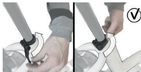
Abbildung 8: Schließen des Schnellspanners der Sattelstütze
