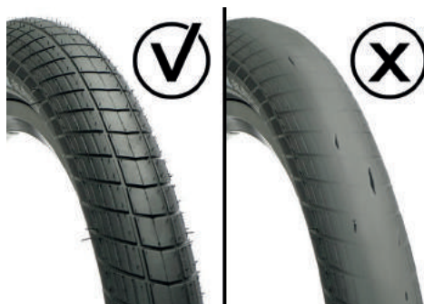
Image 33 : Usure des pneus
