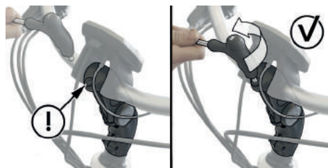
Image 9 : Desserrer le boulon sur la potence
