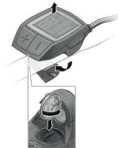
Abbildung 31: Wechseln der Knopfzellen im Purion-Display
