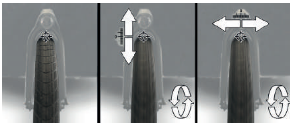
Image 34 : Vérification du décalage de la roue
