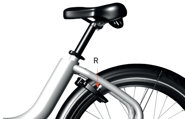
Afbeelding 37: De slotrubbers controleren
