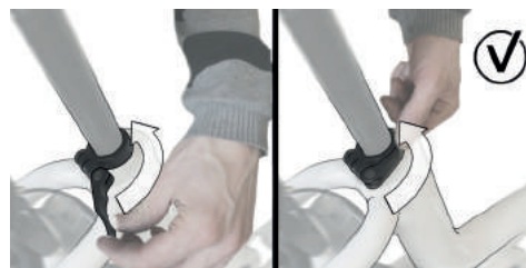
Abbildung 8: Schließen des Schnellspanners der Sattelstütze
