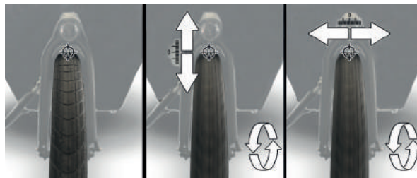
Image 34 : Vérification du décalage de la roue
