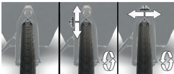
Afbeelding 34: De centrering van het wiel controleren
