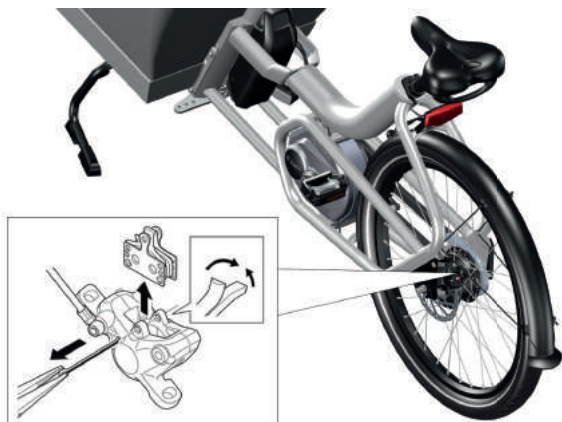
Abbildung 39: Entfernen der Bremsbeläge, um sie auf Verschleiß zu prüfen
