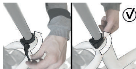
Image 8 : Fermer le blocage rapide de la tige de selle
