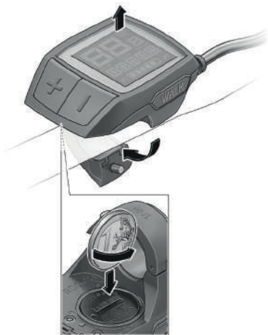
Abbildung 31: Wechseln der Knopfzellen im Purion-Display
