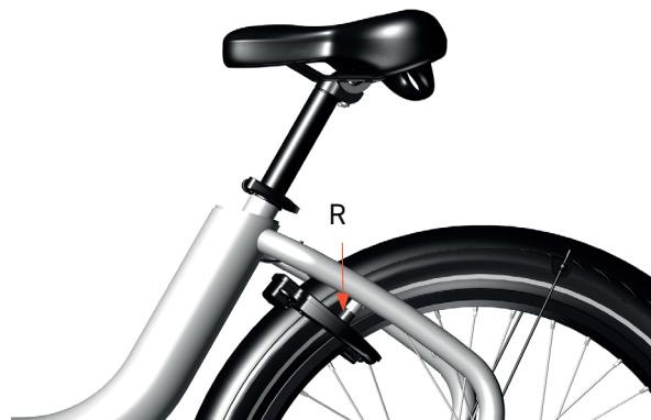
Image 37 : Vérification des caoutchoucs de verrouillage
