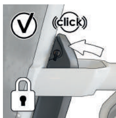
Afbeelding 18: Terugmelding juist geplaatste accu
