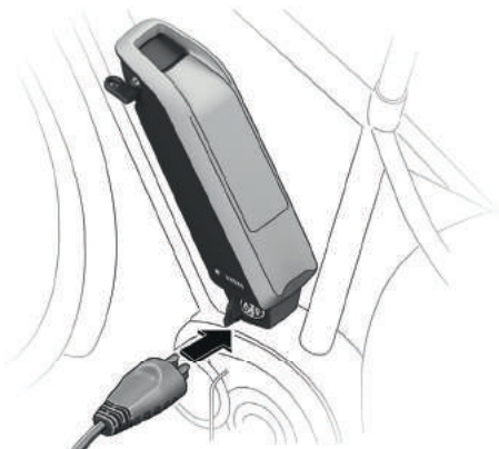
Abbildung 29: Einstecken des Ladegerätesteckers in die Ladebuchse am unteren Teil der Akkuhalterung
